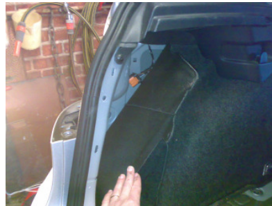
2 Kunststoffmuttern mit 13er Nuss entfernen
