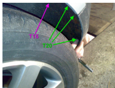
4 Torx Schrauben pro Radlauf müssen entfernt werden
