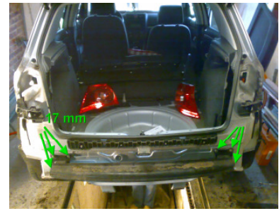
Träger demontieren 6 Schrauben mit 17er Nuss (Träger / Schrauben = Müll)
