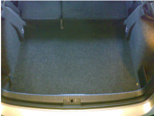
Bodenverkleidung Teppichplatte entfernen
