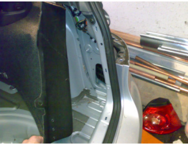
Verkleidung zur Seite drücken und Kabel von Rückleuchte entfernen
