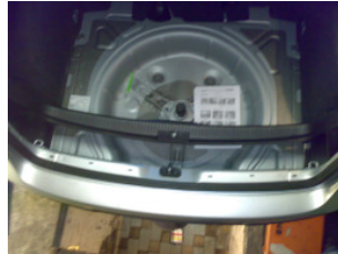
Heckblech- verkleidung heraushebeln
