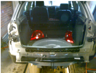
Träger in nun sichtbare Führung schieben Seitlich von unten...
